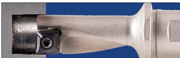
2.2- Растачивание сверлом DRG-MF
