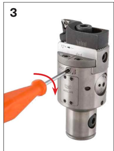
Картридж должен быть установлен в соответствии с направлением отметки пластины
