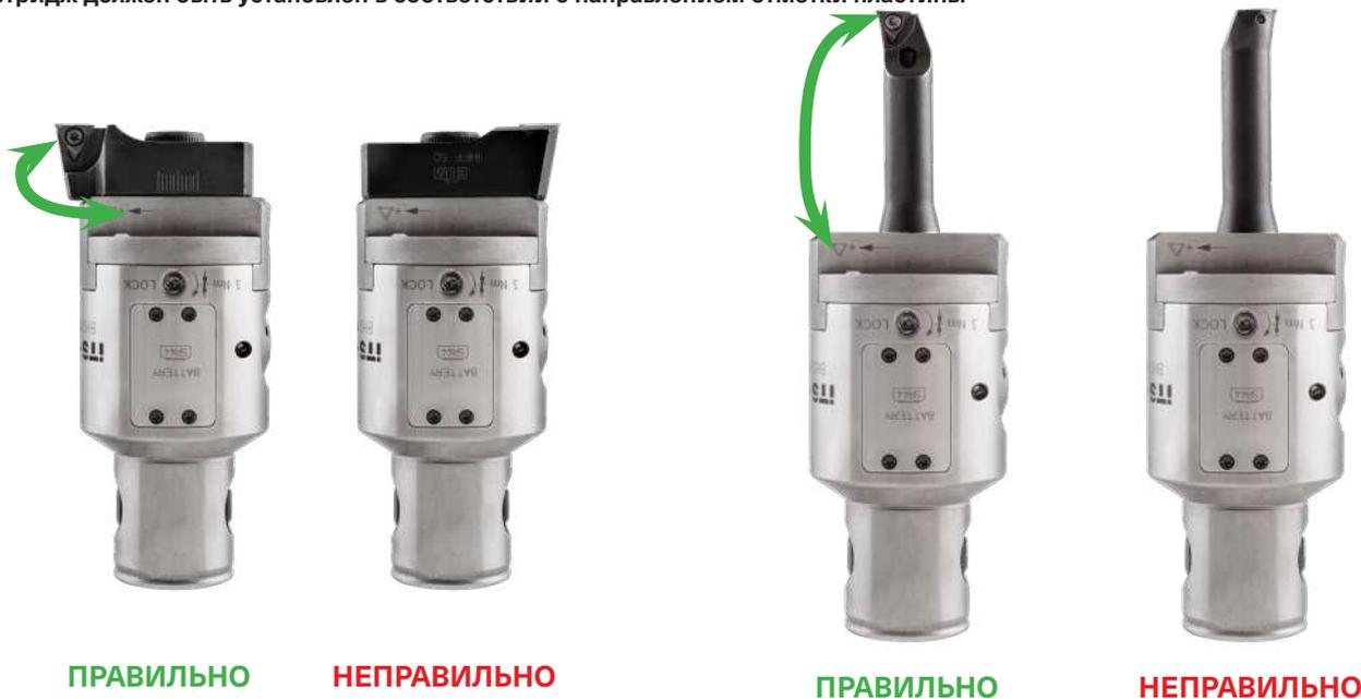
**Предупреждение:** положение направляющей должно быть отрегулировано в указанных пределах. Чрезмерные движения повреждают внутреннюю кинематику
