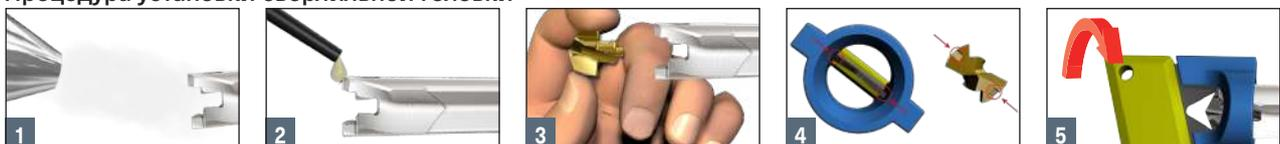
При применении ружейных сверл на токарном станке необходимо использовать короткие твердосплавные центровочные сверла перед использованием ружейных сверл. Сверло самонаправляется при входе в предварительно просверленное отверстие.
