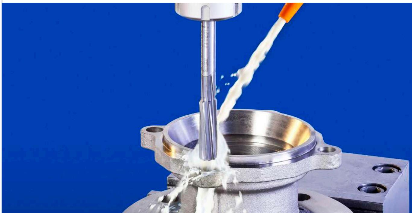
**Высокоскоростная система развёртывания с каналами для внутреннего подвода охлаждающей жидкости**
