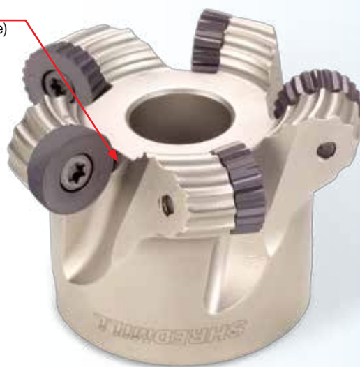
Рис. 8. Круглая пластина с гладкой режущей кромкой, установленная для улучшения параметров шероховатости поверхности обработки
