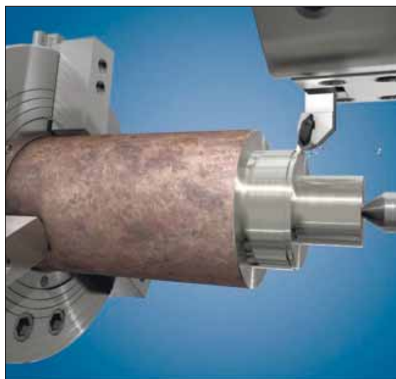
Используйте заднюю бабку для длинных заготовок
