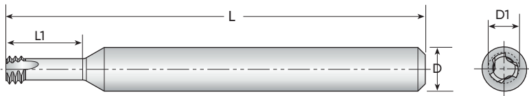
Левая фреза, вращение против часовой стрелки
