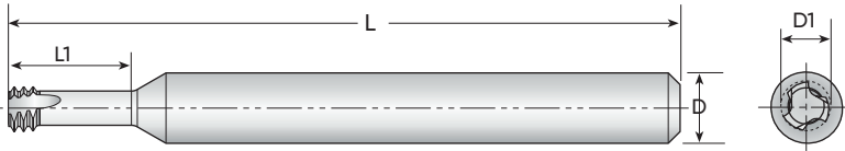
Левая фреза, вращение против часовой стрелки
