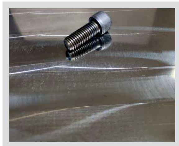
фото поверхности после испытаний, R_a = 0,2-0,3 мкм
